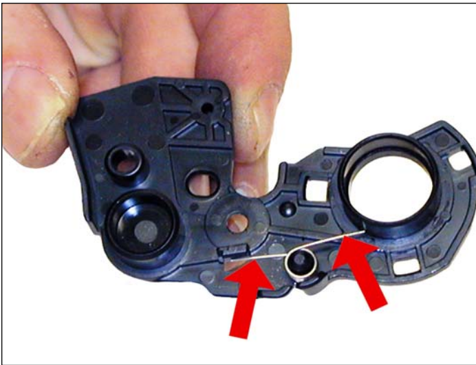
28. Con el resorte de la tapa del OPC tal como se muestra montar el lateral. Levantar el extremo del resorte para fijarlo a la tolva.
