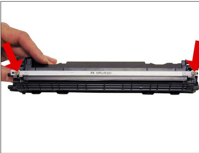
17. Retirar la cuchilla dosificadora y sus dos tornillos.
